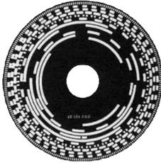
Comme on le constate sur ces exemples, le bit de poids fort est au plus proche de l'axe du disque, et le bit de poids faible à la périphérie. Ceci est dû au fait que la couronne des bits de poids faible est susceptible de comporter un nombre très important d'alternances pour les codeurs optiques à grande précision, comme on peut le constater sur le codeur optique 12 bits ci-contre.
